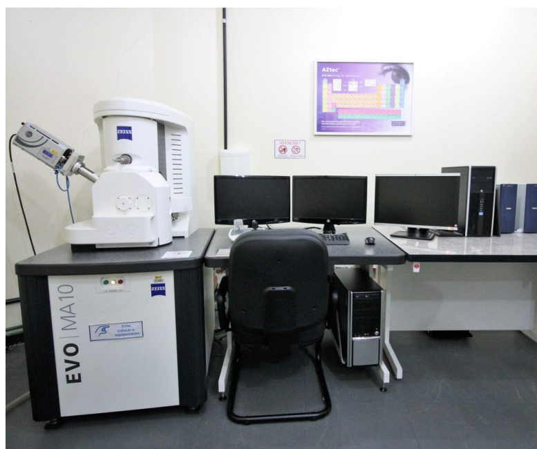
Рисунок 1. Внешний вид сканирующего электронного микроскопа EVO MA10
