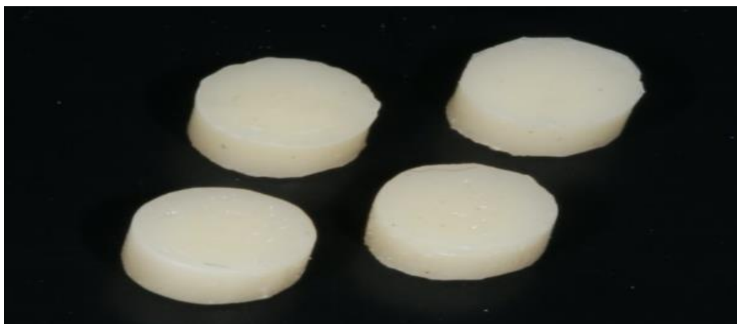
Рис. 1. Образцы пломб из Estelite Posterior для определения поверхностной микротвердости материала
