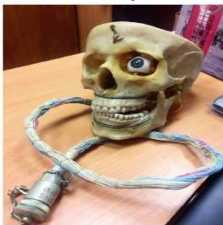
Рис. 4. Электрический симулятор с обратной связью для обработки навыков местного обезболивания в стоматологии (примерно 1990 г.): а) общий вид симулятора; б) целевые пункты
